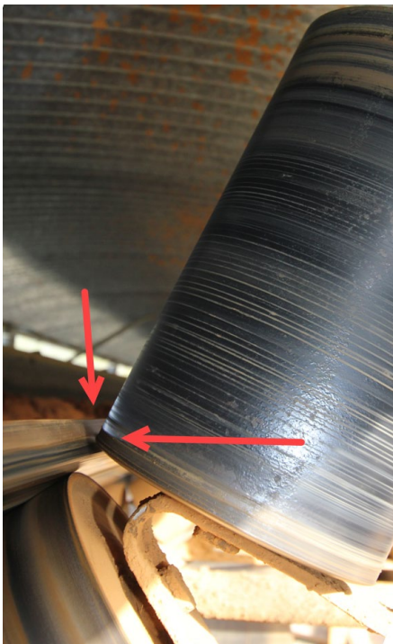
Fig.18 : Support à 5 rouleaux, le talon de bande bute sur l'arête du rouleau extérieur
