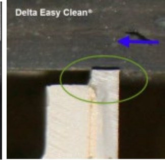
Figure 3.2 : bande avec revêtement « Easy Clean® » La pression de la lame n'impacte pas le profil plan et constant du revêtement Easy Clean de la bande.
