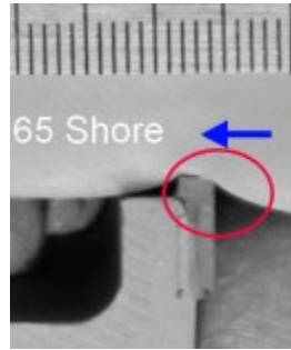
Figure 3.1 : bande avec revêtement standard La pression de la lame forme un bourrelet de gomme devant le racleur. CQFD !
