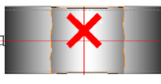
Fig.4 : Profil concave par usure
