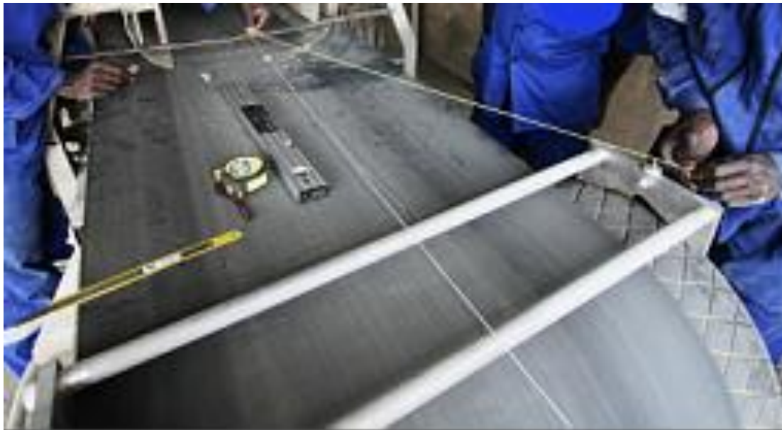
Mesur des côtés du triangle entre les vés et l'axe convoyeur
