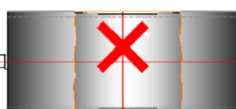
Fig.4 : Profil concave par usure
