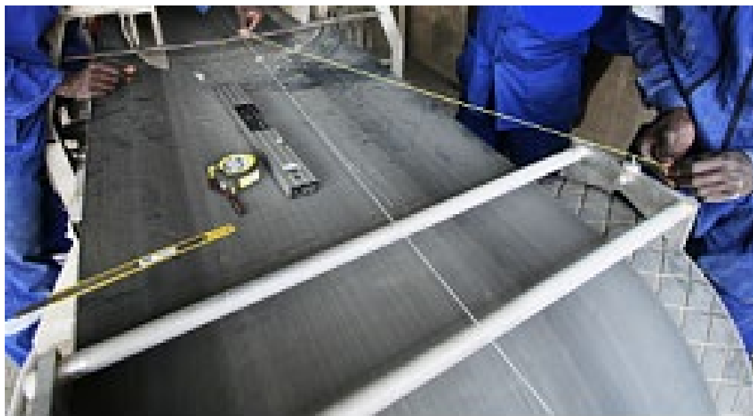
Mesure des côtés du triangle entre les vés et l'axe convoyeur
